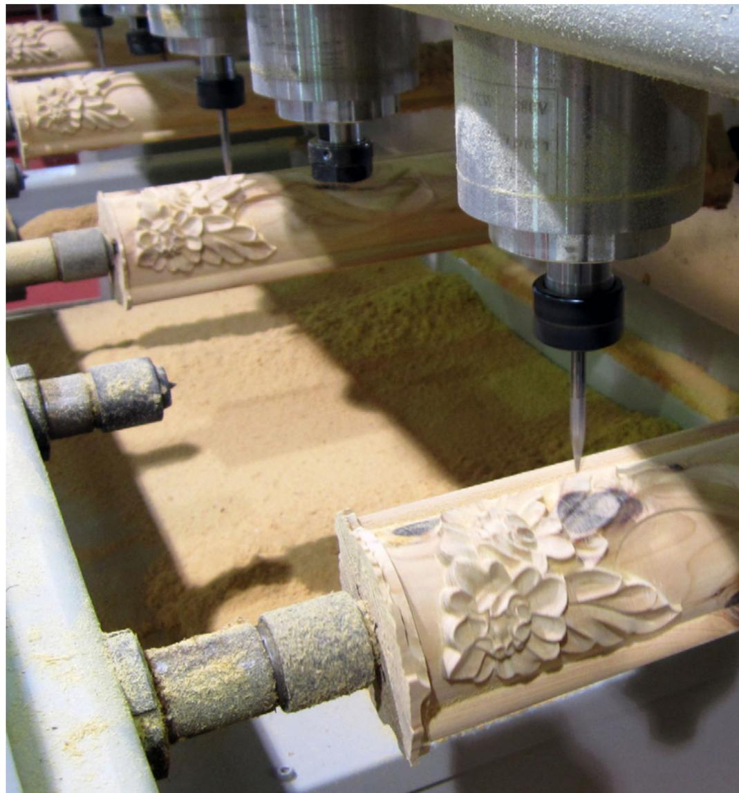
目前的雕刻加工主要运用的方法是先手工雕刻出一个实物，再用三维扫描仪扫描进入计算机，通过软件最后实现三维建模。这种建模的过程必然有其优势，但在实际使用中也有一些问题。
