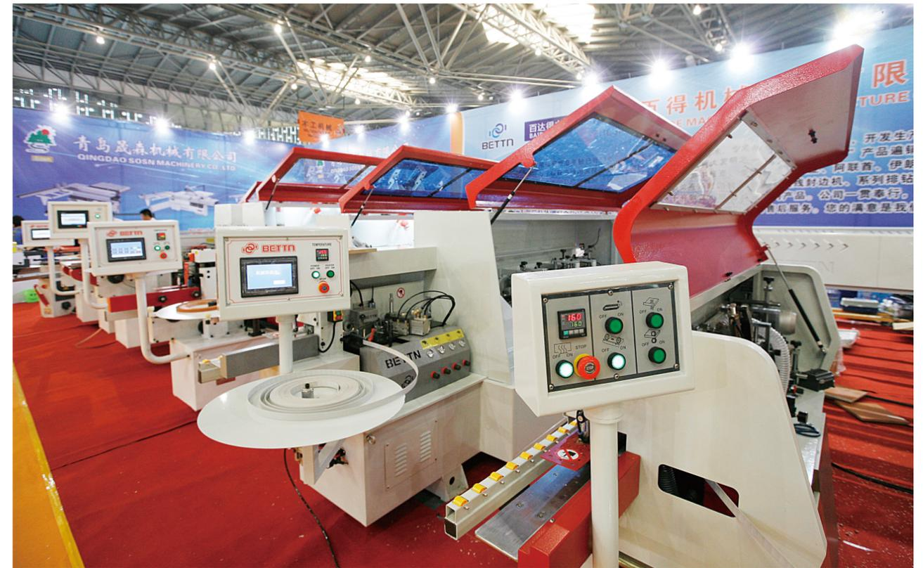
板式家具是以各种人造板作为家具部件，借助五金连接件、木榫等组装而成的家具。板式部件的边部处理是板式家具生产过程中非常重要的一个加工环节，直接影响板式家具的外观和质量。在板式家具的生产中，封边是最重要也是最常用的一道工序，同时也是产品质量问题最多的工序。本文针对板式家具的封边工艺及其质量影响因素进行简要论述。
