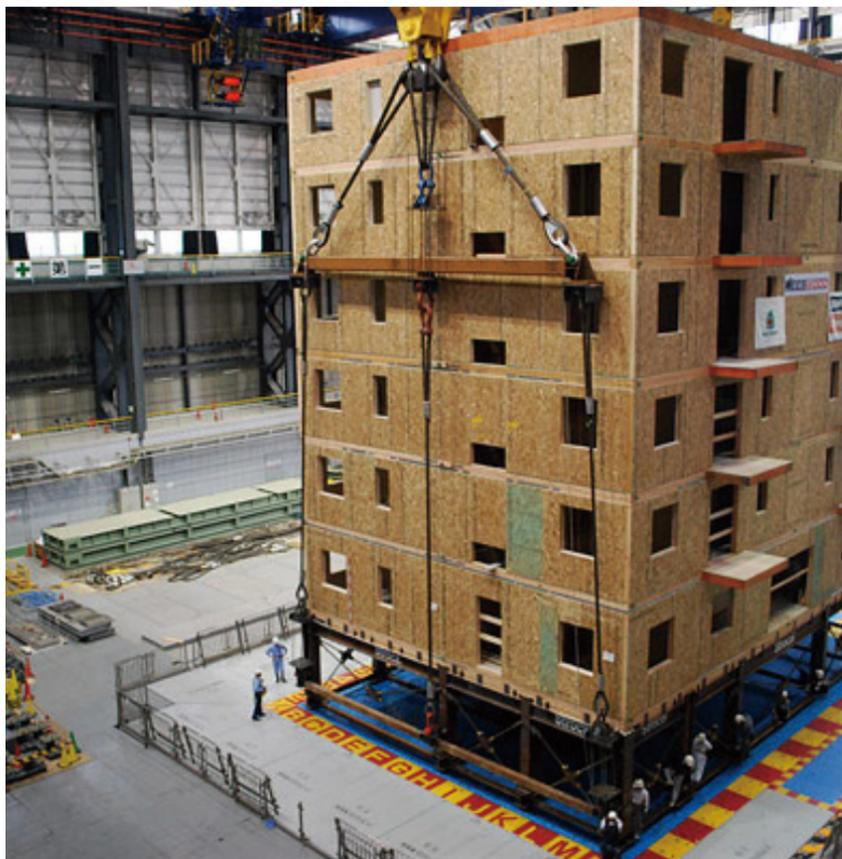
轻型木结构在高地震区的应用实验
