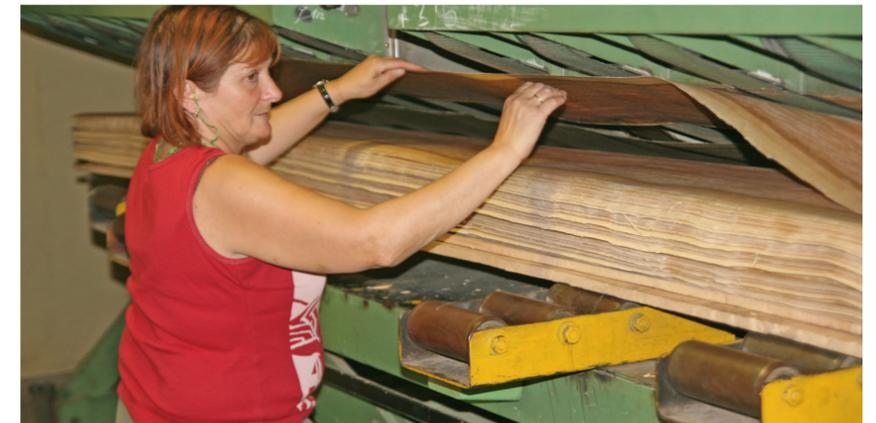
3) 薄木拼缝：由于薄木幅面比较狭窄，使用时需要胶拼。定宽后的薄木要在24小时之内拼缝完毕。若在24小时内未能拼缝完毕，应将剩余的薄木放在平整的工作台上，并用黑丝塑料布罩好，用重物压平。复杂图案要手工操作，批量生产的简易拼合可在拼缝机胶拼。
