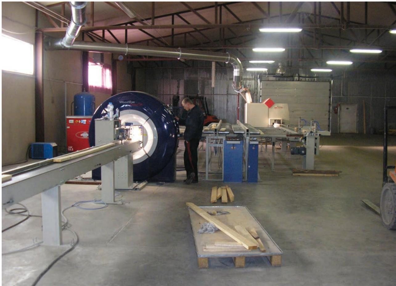
图2 独立的木材表面缺陷检测设备
